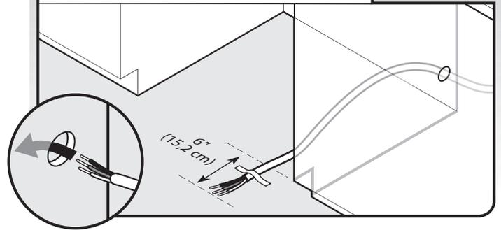
Installer un câble depuis le tableau de distribution jusqu'à la cavité d'encastrement du lave-vaisselle, à travers le trou percé dans la paroi (la longueur du câble doit être suffisante pour que les conducteurs atteignent l'emplacement indiqué sur l'illustration). Fixer le câble sur le sol avec du ruban adhésif à l'emplacement indiqué, pour qu'il ne puisse bouger lors de l'insertion du lave-vaisselle dans la cavité.
